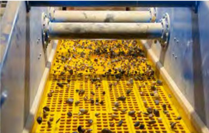
Die Anlage ist zweigeteilt. Auf der einen Seite wird das Rundkies aufbereitet. Grosse Rüttelsiebe selektionieren das Material nach verschiedenen Normgrößen.
